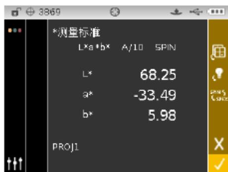
可在配置模式将仪器设置为“自动选择”或“手动选择”标准。在“自动选择”模式中，仪器会自动选择与被测样品最接近的标准。在“手动选择”模式中，您必须在开始测量前选择标准。手动选择的标准会一直沿用，直到选择了其它标准。
