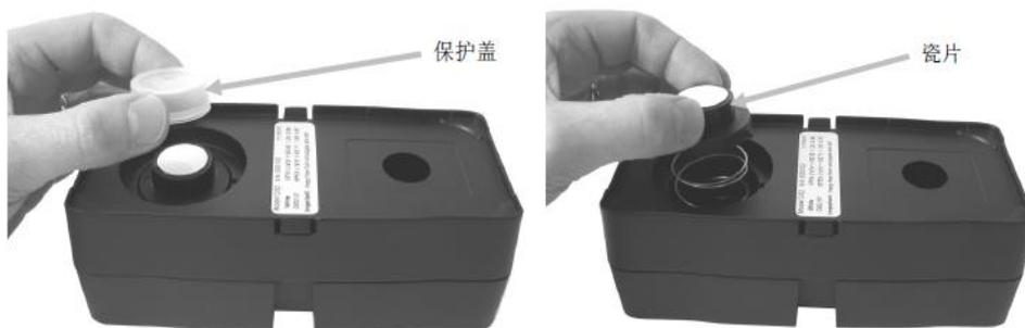
b) 使用温和的肥皂温水清洁瓷片。用温水彻底冲洗 然后用无绒布擦干。切勿使用任何种类的溶剂或清洗剂。瓷片完全干透后，将瓷片边缘上的大凸舌和基座上的大凹槽对齐。通过瓷片向下按压弹簧直到不能再往下压。按住瓷片，顺时针旋转直到不能再转动。慢慢地让瓷片升起。正确放置时，瓷片上的箭头和基座上的箭头应对齐。不使用瓷片时，将保护盖重新安装到瓷片上方。
