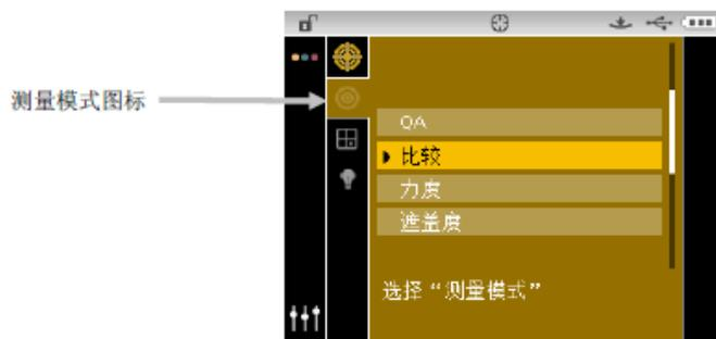
b) 回到主测量屏幕
